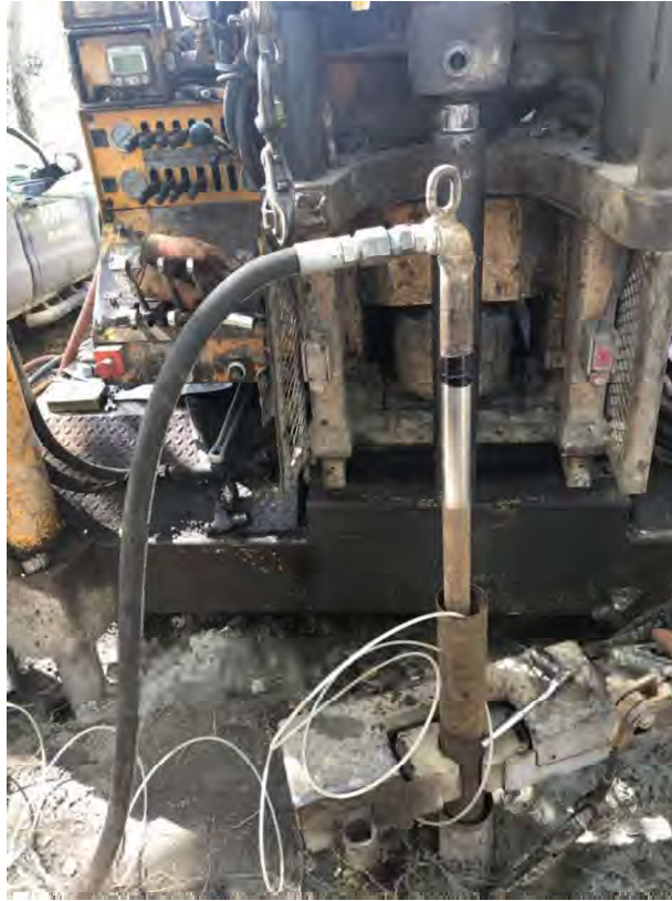
Photo 3 Installation pour les essais Lugeon
