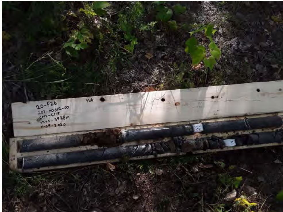
Photo 1 Carotte de roc du forage F-26 au contact de la carbonatite et du grès quartzitique (37,22-39,88 m de profondeur)
