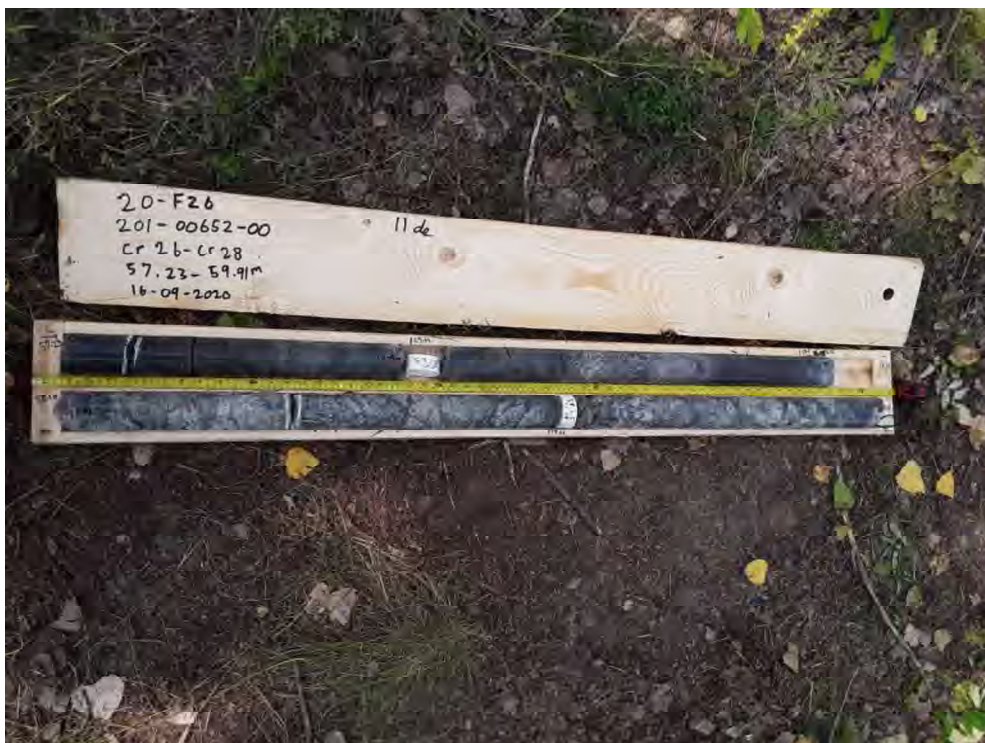
Photo 2 Carotte de roc du forage F-26 dans l'intrusion bréchique (57,23-59,91 m de profondeur)
